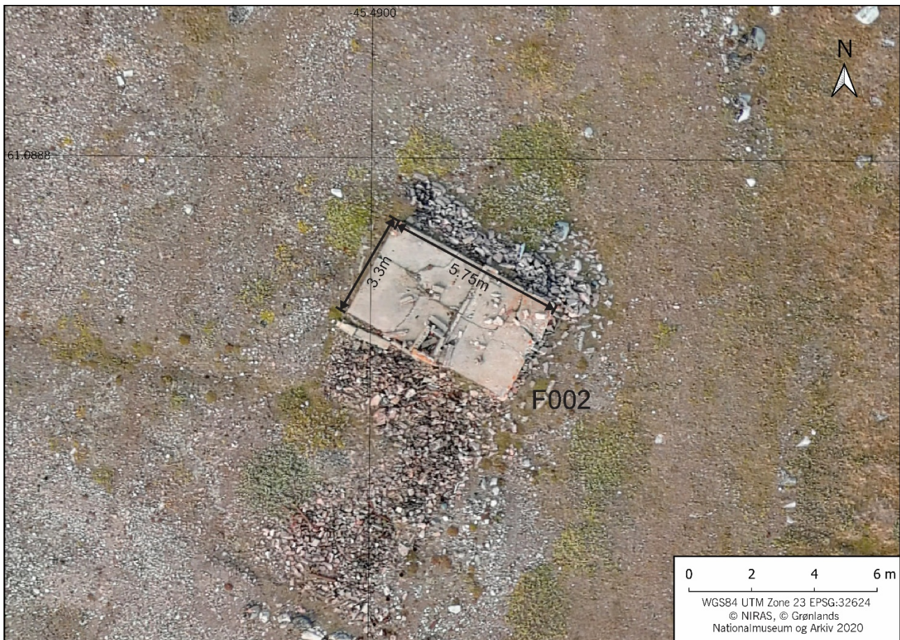
Fig. 82. Luffoto af anlæg F002, betonfundament, på Artillery Point. Gamle rør og en bunke af ødelagte sten fundet omkring fundamentet tyder på, at bygningen tidligere kan have strakt sig over et større overfladeareal. Foto: NIRAS, 2020.
