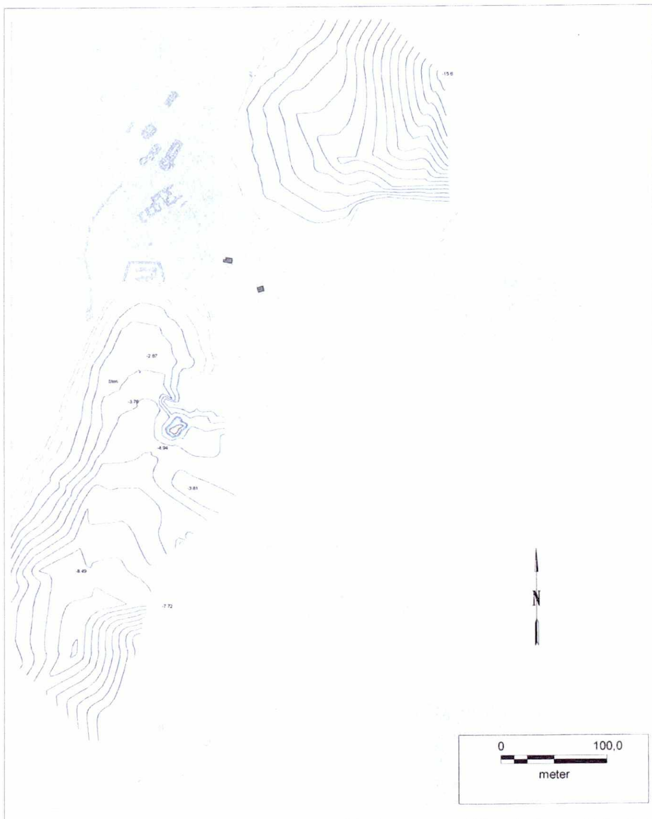
Fig.6. De blå kurver viser bundprofilen med en ækvistand på 1 m. Dybdeangivelserne er niveauet i forhold til middel vandstand. Skær, og øer er ikke indmålt, men udtegnet fra luftfotos.
