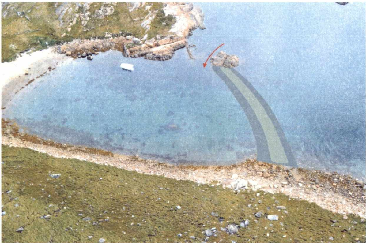
Figur 7. Dæmningen placering vist på skråfoto. Det smalle løb mellem skæret og den fast klippe har ved middelvande en dybde på ca. 1,20, hvilket vil muliggøre passage med mindre motorbåde.
