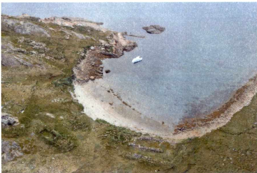
Figur 5. Luftfoto taget af Iscentralen, sept. 2013. Erosionskanten er nu så tæt på kirkens sydvæg, at denne vil forsvinde, hvis der ikke hurtigt gribes ind. Bemærk hvor lidt der nu er tilbage af den i 1991 udlagte kystsikring.
