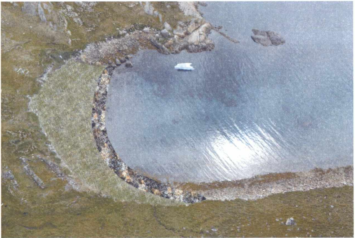
Figur 11. Løsningsforslag B er en lav forkastning placeret tæt på land, og udlagt i en højde som svarer nogenlunde til kystbrinkens vegetationskant. Området på forkastningens bagside fyldes op og tilplantes med græs.
