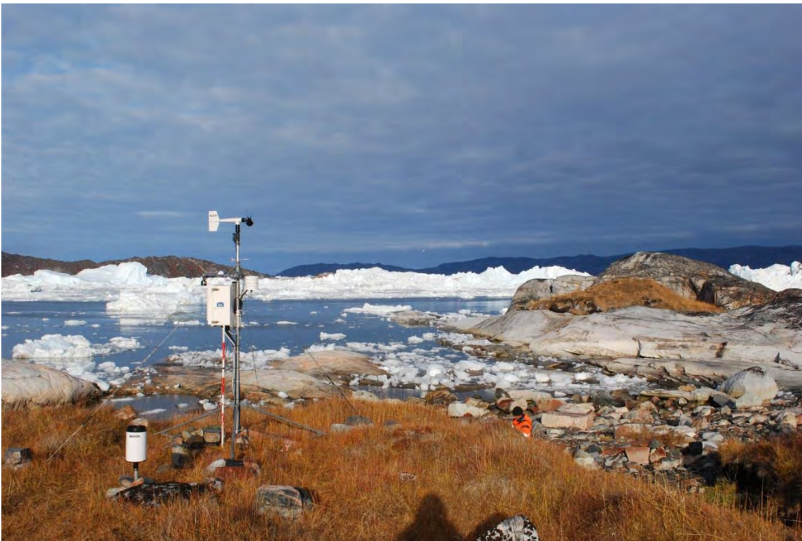
Figur 16: Den opstillede vejrstation og nedbørsmåler
