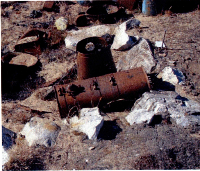
Fig. 16. (herover): Tv: Tank fra Delco Light generator liggende i fundament under bislag. Th: Delco Light installeret i stationshuset på Eskimonæs (fra Koch 1955)
